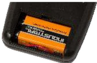
Legen Sie die Batterie in das Batteriefach ein und achten Sie dabei darauf, dass sich der Batterieanschluss (von Ihnen aus gesehen) auf der linken Seite befindet und das Batteriekabel am Boden des Batteriefachs entlang verläuft.
