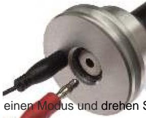
Stellen Sie sicher, dass der ElectroPebble ausgeschaltet ist und beide Pegelregler heruntergedreht sind. Stecken Sie den 3,5-mm-Klinkenstecker in eine der Ausgangsbuchsen. Schalten Sie den ElectroPebble ein. Wählen Sie nach Abschluss der Startsequenz einen Modus und drehen Sie den entsprechenden Pegelregler *langsam* hoch, bis Sie ein Kribbeln an der Elektrode spüren.
